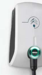
Une borne Wall Box peut être installée à votre domicile : elle permet une recharge de 0 à 100% en 7h30, en monophasé, et même en seulement 5h, en triphasé avec le chargeur optionnel de 11 kW. Bornes de 11 kW que vous pouvez trouver également en ville sur la voie publique.
